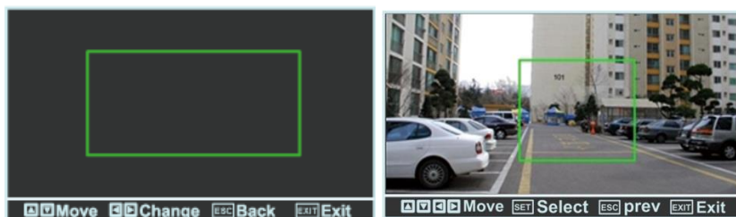
Рис. 7 Экран меню ANGLE VIEW с указательными линиями для настройки фокуса определённой области изображения
