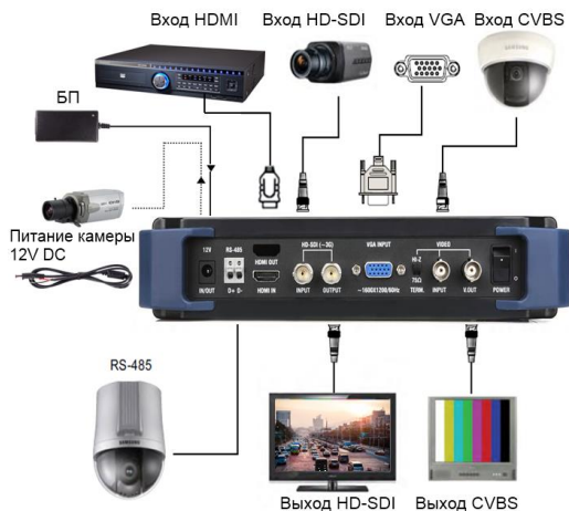
Рис. 4 Схема подключения тестера TS-HD-7
