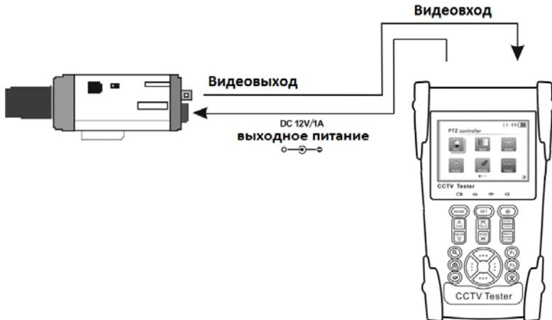
Рис.55 Передача питания от тестера к камере.
