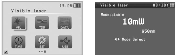
Рис.47 Подменю Visual Fault Locator
