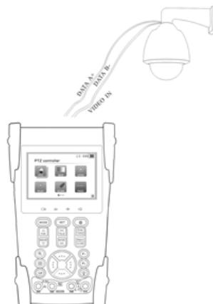
Рис. 8 Подключение к тестеру PTZ-камеры.
