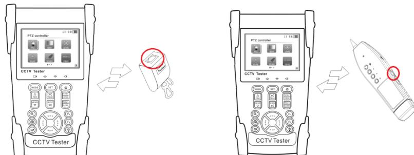
Рис. 25 Подключение к тестеру заглушки.
