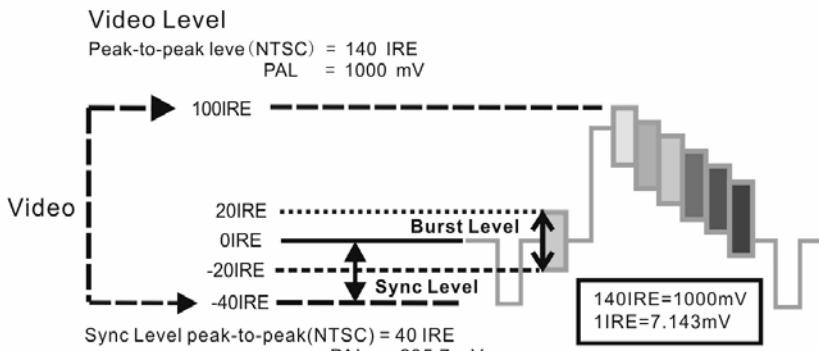
Рис.15 Пример отображения видеосигнала на осциллографе.
