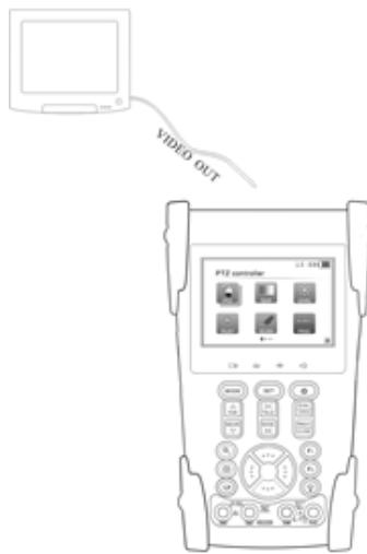
Рис. 12 Подключение к тестеру монитора.
