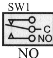
Рис.10 Схематичное изображение датчика нормально-разомкнутого типа срабатывания
