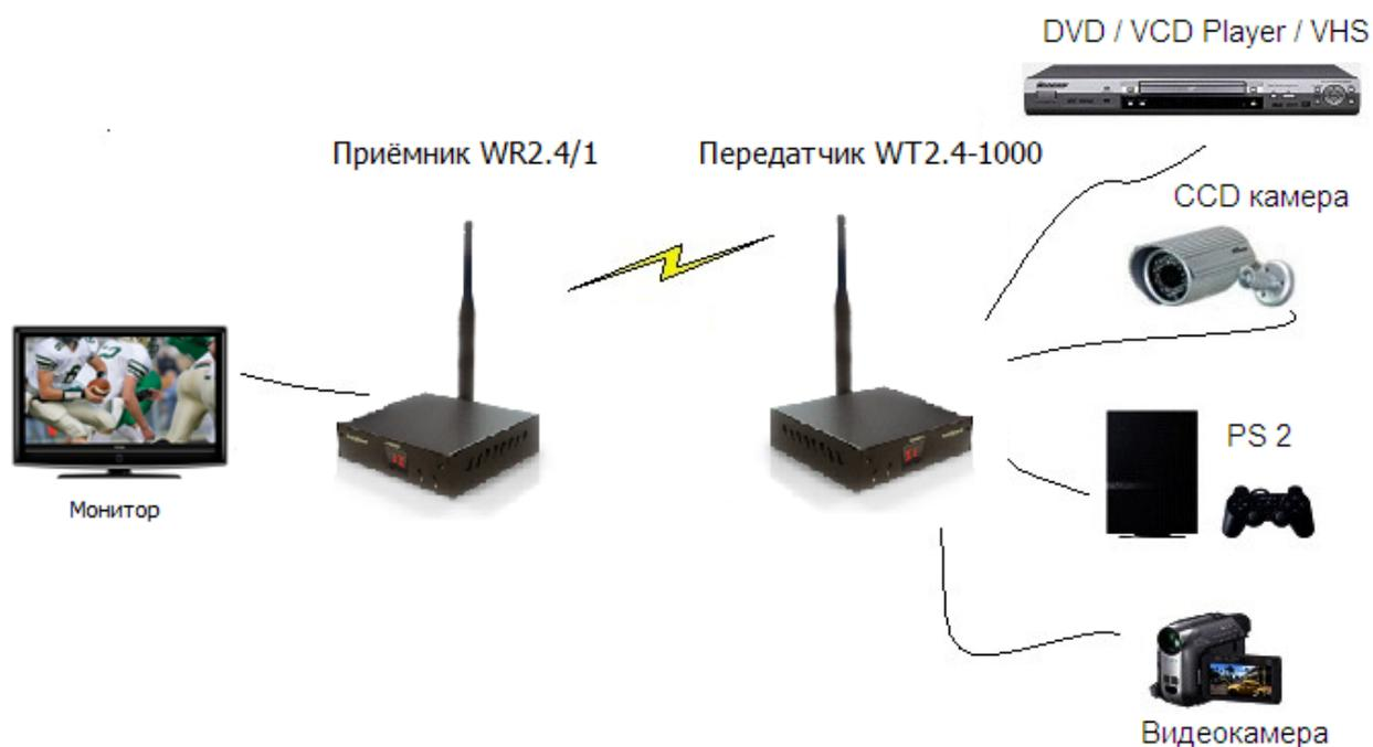
Рис.2 Схема подключения передатчика WT2.4-1000 и приемника WR2.4/1.
