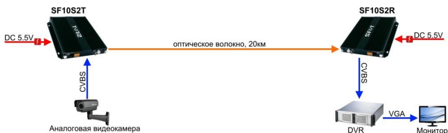
Рис. 6 Типовая схема подключения оптического передатчика SF10S2T и оптического приемника SF10S2R
