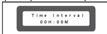
2) Нажатием клавиши "часы" можно установить часы в диапазоне от 00 до 23 часов (всего 24 часа). После цифры 23 следует 00. При удерживании клавиши нажатой более 1 секунды происходит автоматическое быстрое переключение на более высокую позицию.
