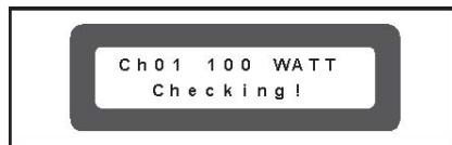
появляется надпись "проверка" ("CHECKING"). После окончания проверки, на дисплее появляется детальная информация и сравнение с предыдущими данными. Расхождения между новыми данными и предыдущими сохраненными данными, появляются на дисплее.
