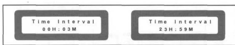
4) Для сохранения настройки временного интервала проверки, следует нажать клавиши "HOUR" и/или "MINUTE" вместе с клавишей сохранения в память MEMORY. Состояние памяти отображается следующим образом: "Writing ok", если новая величина сохранилась и память не содержит ошибок; "Back-up error" если новая величина сохранилась, а память содержит ошибки. (если на дисплее появляется надпись "Back-up error", поменяйте неисправную память на исправную того же типа.)
