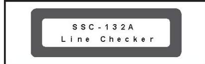
Если отсутствует запись о предыдущей неисправности оборудования, то на дисплее отсчитывается время посекундно. На дисплее отображается время автоматической проверки, установленное пользователем.
