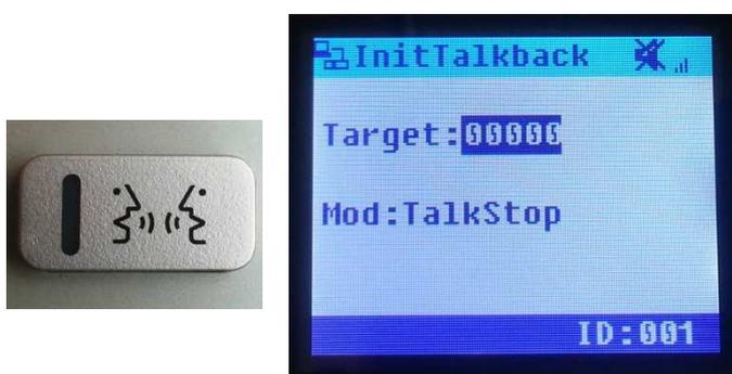
В этом режиме, происходит исходящий вызов на выбранную вызывную панель. Для этого нужно указать номер сетевого контроллера и целевой вызывной панели. После нажатия кнопки "ОК" начнётся вызов. Прервать разговор можно, нажав на кнопку "С".
