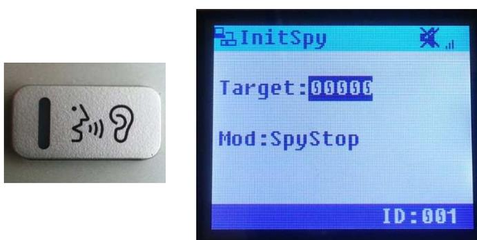
Как и в предыдущем меню, при выборе целевой вызывной панели, или панелей, после нажатия кнопки "ОК", встроенный громкоговоритель воспроизводит звуки, попадающие в поле работы микрофонов выбранных вызывных панелей. Нажатие на кнопку "С" отключает этот режим.
