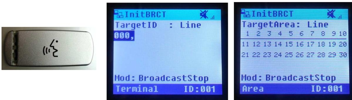
В данном режиме осуществляется вещание по зонам, или отдельно выбранным сетевым контроллерам. Звук может быть направлен как в громкоговорители вызывных панелей, так и на линейный выход сетевого контроллера. Начало и окончание трансляции сопровождается звуком гонга.
