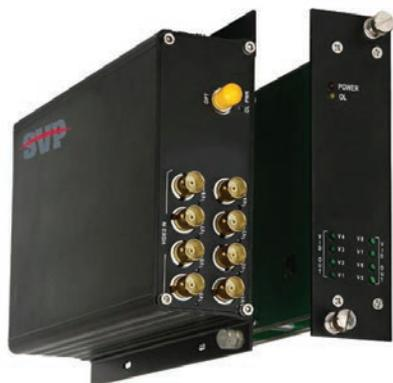
Оптоволоконные устройства серии SVP-800 обеспечивают передачу 8 видеосигналов по одному многомодовому или одномодовому оптическому волокну с использованием 10-битного цифрового кодирования высокого качества.
