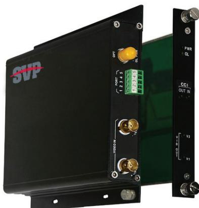
Оптоволоконные устройства серии SVP-210CB обеспечивают передачу 2 цветных видеосигналов с использованием 10-битного цифрового кодирования высокого качества и 1 двунаправленный сигнал замыкания контактов («сухие» контакты) по одному многомодовому или одномодовому оптическому волокну.
