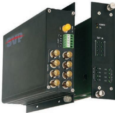
Оптоволоконные устройства серии SVP-8X0AB обеспечивают передачу 8 видеосигналов с использованием 10-битного цифрового кодирования высокого качества с 1 или 2 двусторонними 24-битными цифровыми аудиосигналами по одному многомодовому или одномодовому оптическому волокну.
