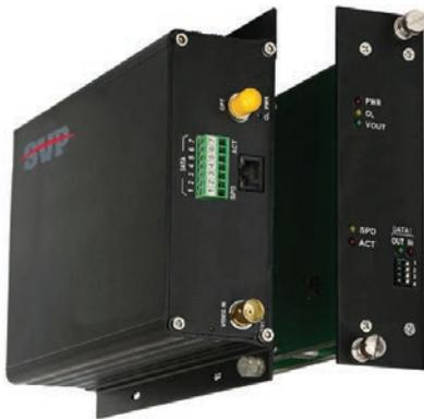
Оптоволоконные устройства серии SVP-110DBE обеспечивают передачу 1 видеосигнала с использованием 10-битного цифрового кодирования высокого качества, приемо-передачу 1 сигнала управления (данных) и 1 сигнала Ethernet со скоростью 100 Мбит/с по одному многомодовому или одномодовому оптическому волокну.
