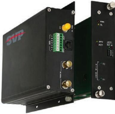
Оптоволоконные устройства серии SVP-210DBE обеспечивают передачу 2 видеосигналов с использованием 10-битного цифрового кодирования высокого качества, приемо-передачу 1 сигнала управления (данных) и 1 сигнала Ethernet со скоростью 100 Мбит/с по одному многомодовому или одномодовому оптическому волокну.
