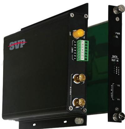
Оптоволоконные устройства серии SVP-2X0DB обеспечивают передачу 2 видеосигналов и приемо-передачу 1 или 2 сигналов управления (данных) по одному многомодовому или одномодовому оптическому волокну с использованием 10-битного цифрового кодирования высокого качества.
