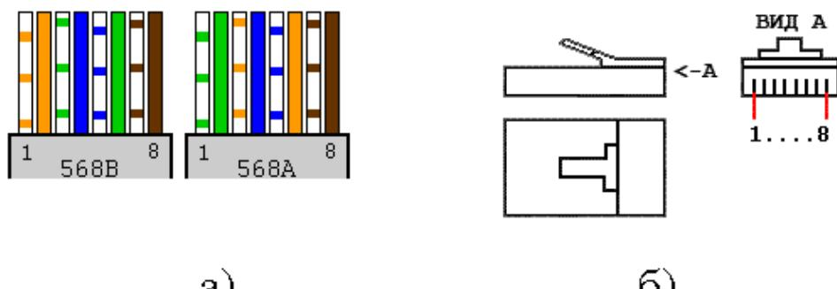
**Рис. 1.11 Стандарты обжима разъемов RJ45 (а) и цоколевка разъема RJ45 (б)**
