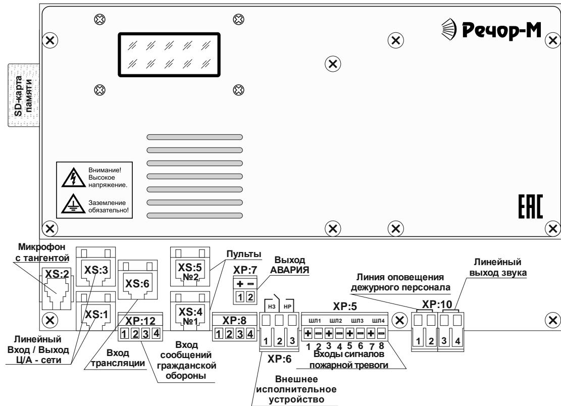
Рис. 1.6 Расположение разъемов для подключения сигнальных цепей БАС-150
