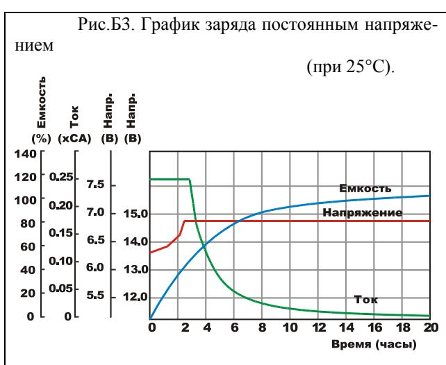
Для моноблоков Delta серии DT диапазон зарядного напряжения буферного режима установлен в диапазоне 2,27–2,30 В/эл-т (при 25°C).
