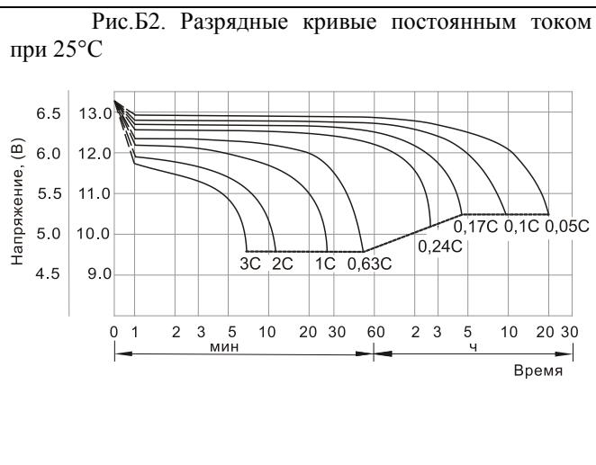
На рисунке Б2 приведены кривые разряда аккумуляторов Delta серии DT постоянным током до определенного конечного напряжения. Разряд до напряжения ниже указанного снижает емкость и срок службы свинцово-кислотных батарей.
