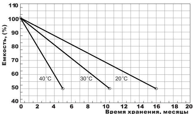
Свинцово-кислотные аккумуляторы обладают саморазрядом, вследствие чего при хранении их доступный заряд со временем уменьшается. Этот процесс описан графиком на рисунке Б7.
