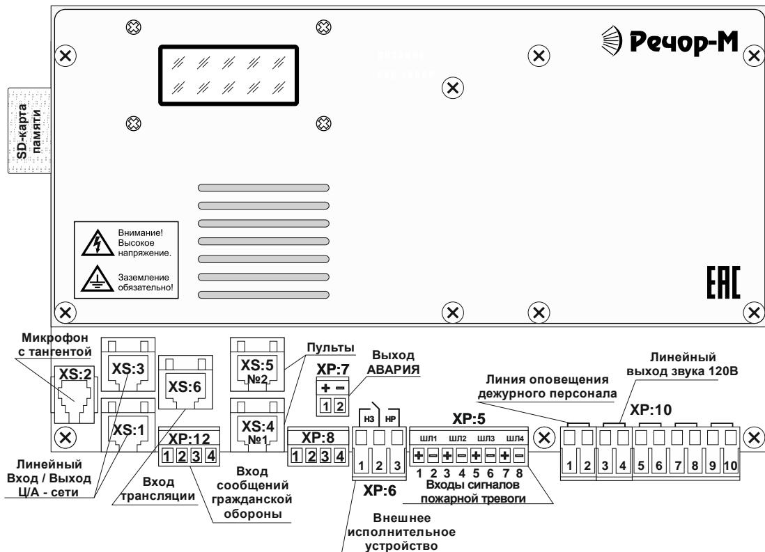
Рис. 1.7 Расположение разъемов для подключения сигнальных цепей БАС-150/4
