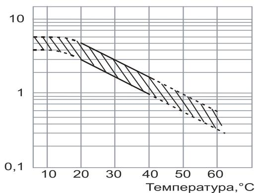
Температура окружающей среды является важным фактором, влияющим на срок службы аккумуляторов. При повышении температуры увеличивается скорость коррозии пластин, вследствие чего уменьшается срок службы. На рисунке Б6 показана зависимость срока службы батарей Delta серии DT от температуры окружающей среды.
