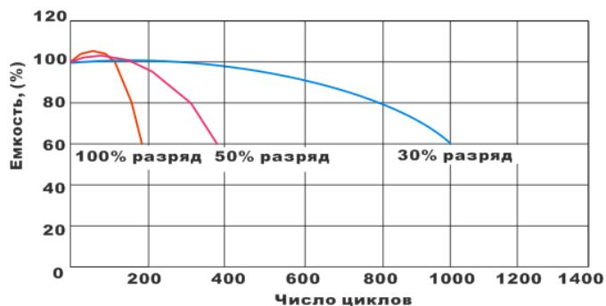
Срок службы аккумуляторов в циклическом режиме работы зависит от целого ряда факторов. Наиболее существенными из них являются рабочая температура окружающей среды, скорость разряда, глубина разряда и способ заряда. На рисунке Б5 показано влияние глубины разряда на количество циклов работы моноблоков Delta серии DT при циклическом режиме.
