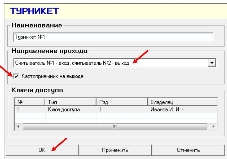
**Внимание!** Если при указании направления прохода выбрано: «Считыватель №1 – вход, считыватель №2 – выход», то картоприёмник должен быть подключен вместо считывателя «B» турникета, а перемычка J1 на кросс-плате турникета должна быть установлена на трёхконтактный разъём в положение «TMB».
