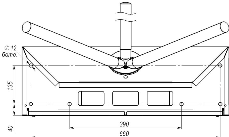
**Рис.6** Основание турникета. Вид снизу.
