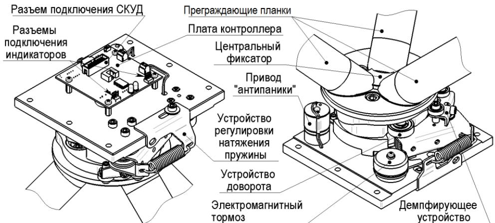
**Рис.5 Механизм турникета (вид верхней и нижней части).**
