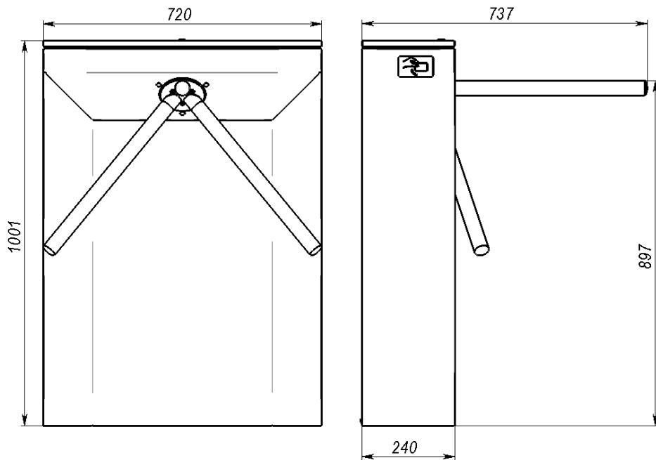
**Рис.7** Турнекет. Габаритные размеры
