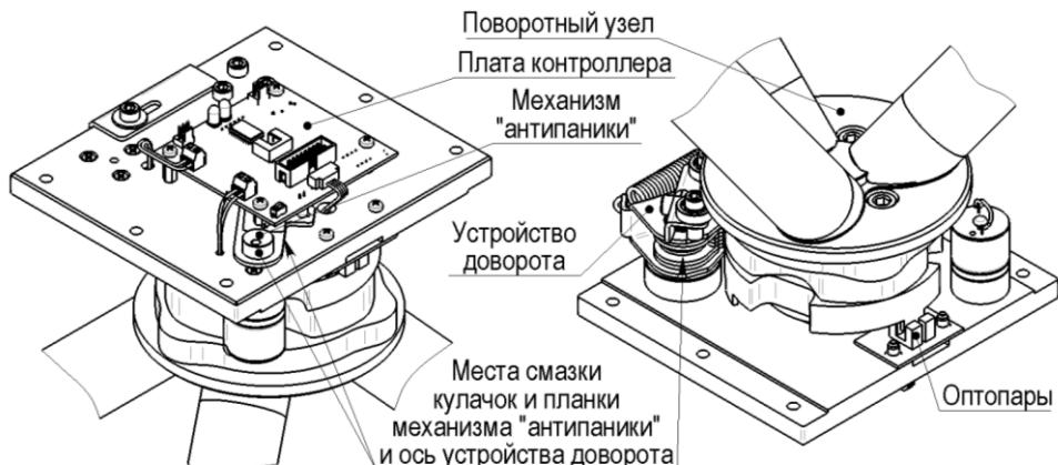
Рис.8 Расположение узлов и деталей трения. Места смазки
