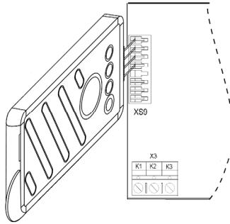
**Рис. 3** Подключение USB-программатора к плате ППКУОП «ГРАНИТ-16/24»
