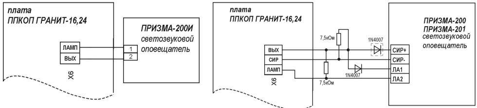
**Рис. 4** Схема подключения светозвукового оповещателя «Призма-200И», «Призма-200» и «Призма-201»
