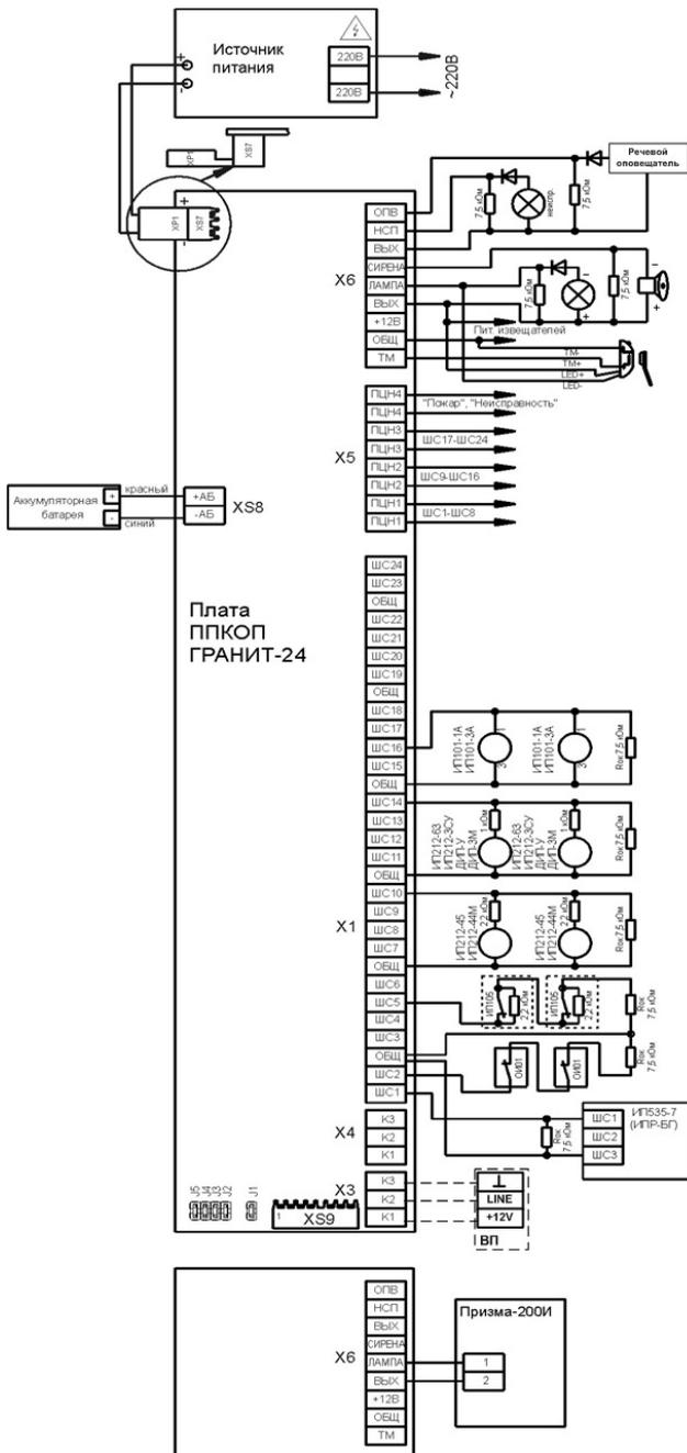
Рис. 2 Схема внешних соединений ППКУОП «ГРАНИТ-24»
