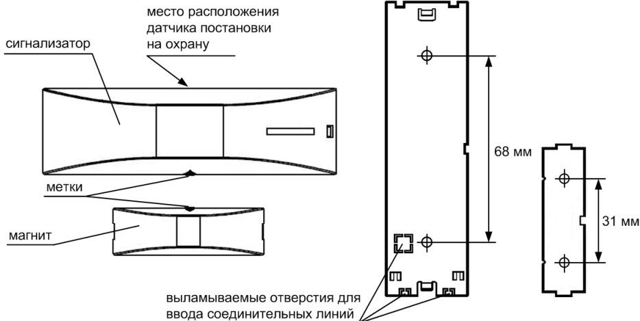
Рис.9 Схема установки, присоединительные размеры
