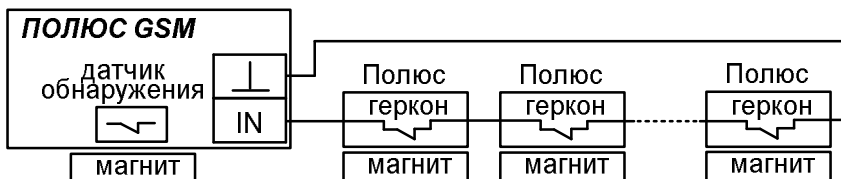
Рис.6а Схема подключения внешних датчиков. Значение «2» в ячейке №37
