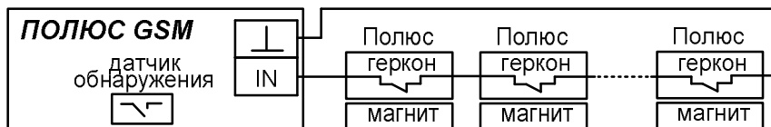
Рис. 6б Схема подключения внешних датчиков. Значение «1» в ячейке №37
