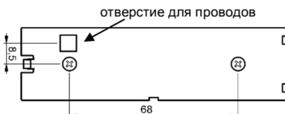
Рисунок 1 – Разметка для крепления к стене
