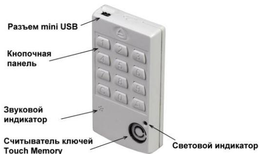
Рисунок 1 – Внешний вид универсального считывателя
