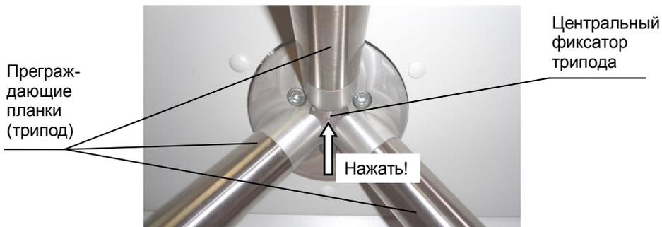
**Рис.4** Место расположения центрального фиксатора трипода
