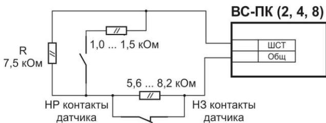
Рис.7. Схема включения технологических датчиков в ШСТ.
