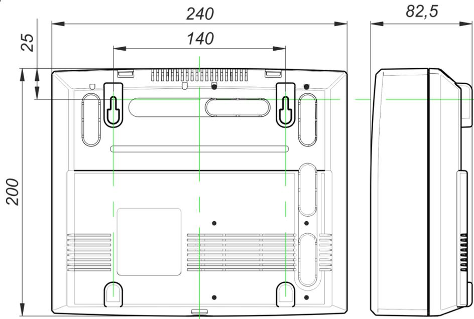
Рис.9. Габаритные и установочные размеры прибора ВС-ПК2(4,8) GSM версия 2.2.
