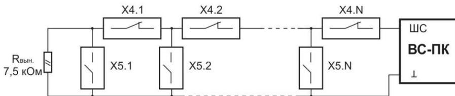
Рис.6. Схема включения охранных извещателей в ШСО.
