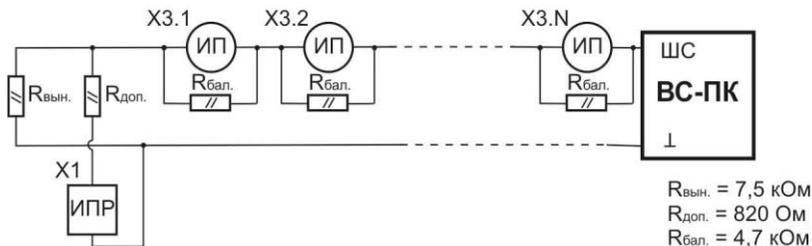
Рис. 4. Схемы включения тепловых извещателей (типа ИП-105) в ШСП.
