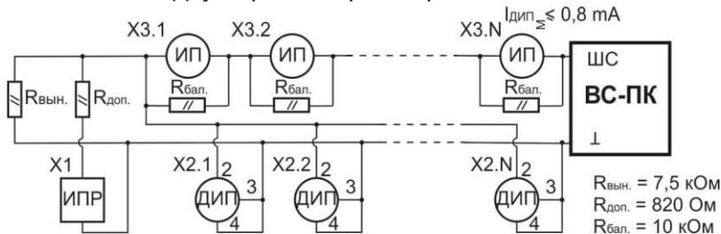
Рис. 5. Комбинированная схема включения в ШСП.
