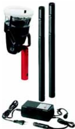
Данный тестер содержит генератор горячего воздуха и работает от аккумулятора. Тестер извещателя будет автоматически приведен в действие при прерывании инфракрасного луча в чаше.
