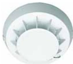
HI320C – очень надежный тепловой извещатель, реагирующий на повышение температуры и достижение температурного максимума; этот извещатель может использоваться в наиболее сложных условиях. Он безотказно реагирует на различные изменения температуры, причем не только на медленное, но и на быстрое ее повышение. База SO320 заказывается отдельно.
