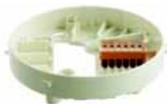
База изготовлена из синтетического материала, устойчивого к ударам и царапинам. Наличие большого отверстия в конструкции базы извещателя удобно для монтажа. Соединительные клеммы без винтов – оранжевые. Предусмотрено место для дополнительных клемм, таких как микроклеммы 0,5 мм<sup>2</sup> или соединительные клеммы 2,5 мм<sup>2</sup>.
