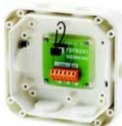
База представляет собой прочный, усиленный стекловолокном пластиковый корпус, обеспечивающий извещателю необходимую изоляцию при монтаже. База включает в себя клеммы без винтов, дополнительные клеммы с изоляцией и шесть кабельных вводов M20 для кабельных сальников.
