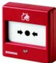
Для немедленной ручной активации пожарной сигнализации. Для установки внутри помещения и за его пределами. Прямая активация сигнала тревоги путем выдавливания стекла. После замены стекла нажимная кнопка возвращается в исходное состояние, и устройство вновь готово к работе. Для открытой и скрытой электропроводки в легкодоступных местах.
