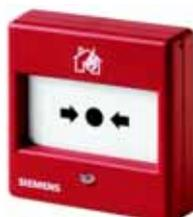
Для немедленной ручной активации пожарной сигнализации. Для установки внутри помещения и за его пределами. Прямая активация сигнала тревоги путем выдавливания пластиковой вставки. Переключатель возвращается в исходное положение с помощью ключа, и устройство вновь готово к работе. Для открытой и скрытой электропроводки в легкодоступных местах.
