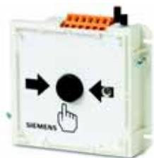
Электронный блок представляет собой устройство двойного действия; для активации сигнала тревоги необходимо разбить стекло и нажать на кнопку. Для подключения к линии коллективных извещателей/извещателей SynoLINE600. Светодиод отображает состояние ручного извещателя. Электронный блок подключается к корпусу при вводе устройства в эксплуатацию. Прилагаемую наклейку «avoid electrostatic charging» приклеивают на переключатель только в тех случаях, когда он используется во взрывоопасных зонах.
