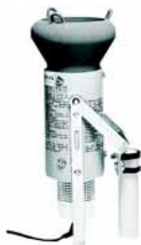
Данный тестер содержит генератор горячего воздуха. Для проверки работоспособности тестер устанавливают над извещателем. Подается горячий воздух, который воздействует на извещатель, в результате чего срабатывает сигнал тревоги.
