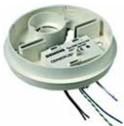
База DBC1191A–AA оснащена встроенным реле. Это позволяет подключить на выходе извещателя простое средство пожаротушения. Контакт замыкается при активации светодиода извещателя. База DB1101A закрепляется с помощью пружинной защелки.
