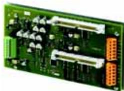
FT2001-A1 имеет 224 выхода для активации светодиода для панелей мнемодисплея. Для подключения к светодиоду используется плоский кабель F50F410 (50-жильный, 24 красных светодиода, длина кабеля 1 м, заказывается отдельно). 2 контрольных выхода для местного зуммера (Local buzzer) и активации светодиода (LED operation). 2 входа для выключения зуммера (Switch-off buzzer) и теста лампы (Lamp test). Встроенный изолятор линии. Питание через FDnet/C-NET; возможно питание от отдельного источника 24 В.
