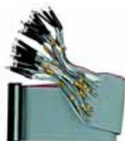
Два кабеля подключения светодиода F50F410 можно напрямую подсоединить к драйверу мнемодисплея для обслуживания всех 48 (224) красных светодиодов. Светодиоды легко можно сконфигурировать с помощью инструментов конфигурации.
