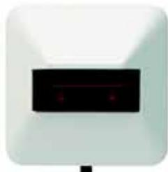
Индикатор тревоги AI322 представляет собой визуальный индикатор, подключающийся параллельно с пожарными извещателями, используемыми на линии извещателей SynoLINE300. Он оснащен темно-красным светящимся элементом на светодиодах. Тревожный индикатор идеально подходит для использования в тех местах, где пожарный извещатель трудно увидеть (например, в номерах гостиниц, распределительных щитах). Индикатор AI322 может использоваться в дверных проемах.
