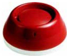
Громкое звуковое оповещение в случае пожарной тревоги, четко узнаваемое как сигнал опасности. Монтаж на стенах или потолках эвакуационных выходов, коридоров, лестниц. Применяется только с базами адресных извещателей. Питание подается через FDnet/C-NET, дополнительного источника питания не требуется. Мониторинг состояния устройства.
