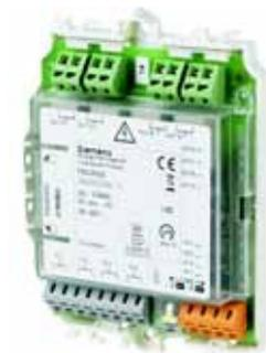
Для VdS-интерфейса устройства активации пожаротушения. 4 входа для «сухих» контактов. Осуществляется мониторинг входящей линии для проверки наличия разрывов и короткого замыкания (оконечные резисторы). Входы могут быть независимо сконфигурованы с помощью станции управления обнаружением пожара для сообщений о состоянии или о тревоге.
