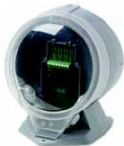
Комплект обнаружения дыма отбором проб воздуха представляет собой систему пассивного мониторинга без собственного насоса. Благодаря разнице давлений в системе вентиляции на устройство обнаружения дыма отбором проб воздуха по обводному воздухо-воду непрерывно поступает поток воздуха из вентиляционного канала.
