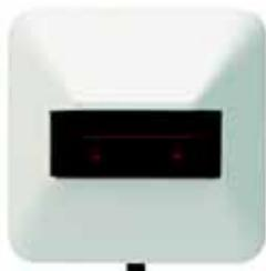
Индикатор тревоги подключается параллельно автоматическим извещателям, чтобы оперативно указывать на источник сигнала тревоги от извещателей, видимость которых и доступ к которым ограничены. Внутри индикатора тревоги находится индикаторная лампа с одним или двумя светодиодами. Светодиоды мгновенно включаются при поступлении сигнала тревоги от извещателя, подключенного к индикатору.
