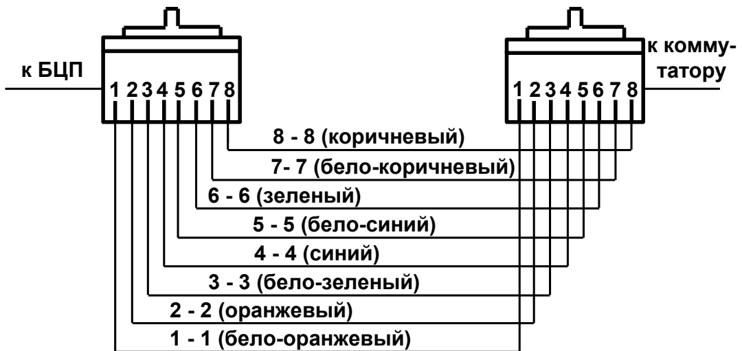
б) Прямой кабель (соединение БЦП и коммутатора)
