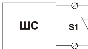
Рис. Схема 5 Подключение НЗ контактов без контроля целостности линии связи.
