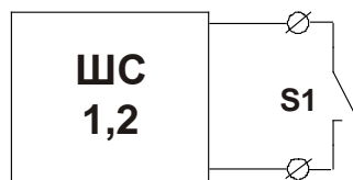
Схема 6 Подключение НР контактов без контроля целостности линии связи.
