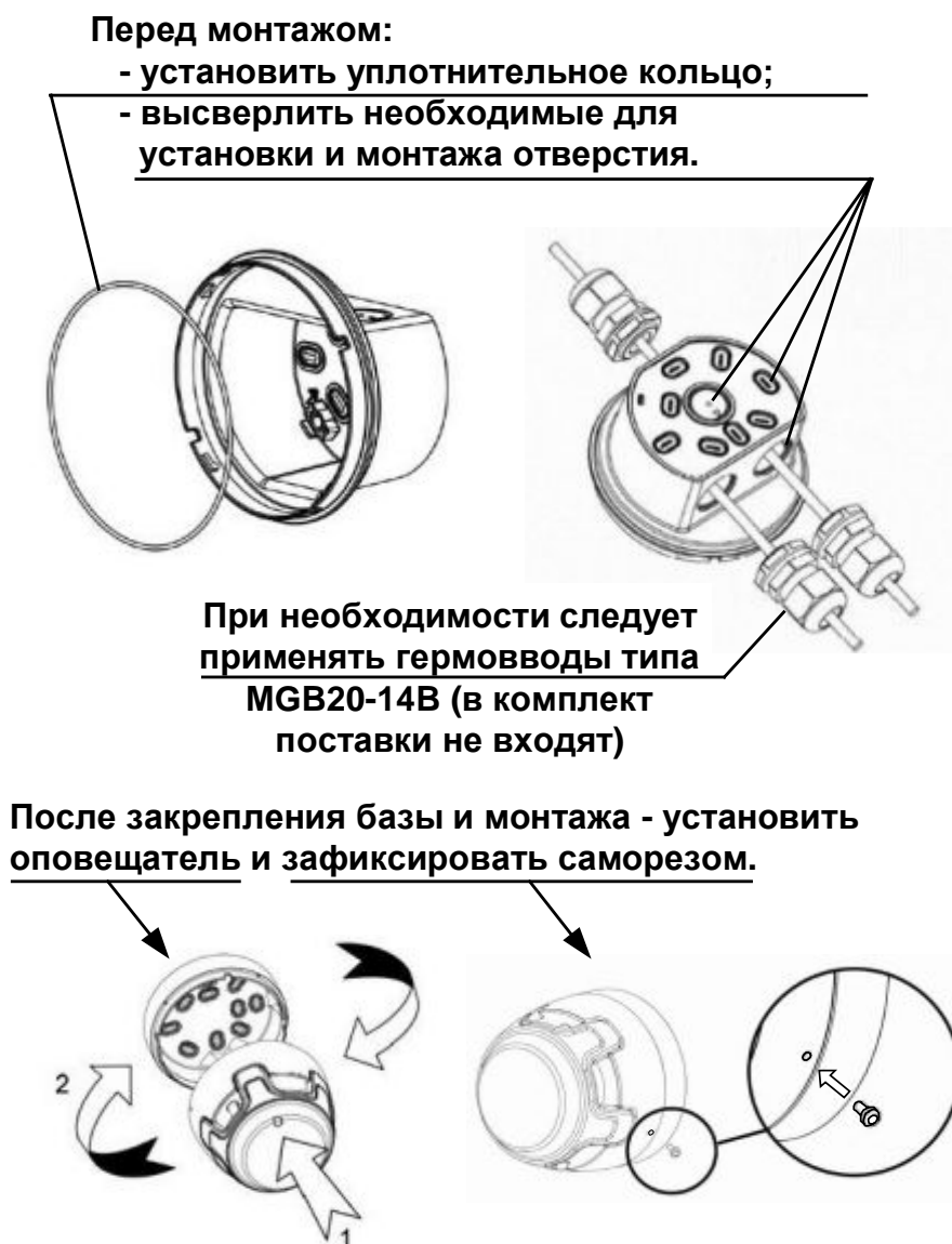
Рис. 4 Сборка и монтаж
