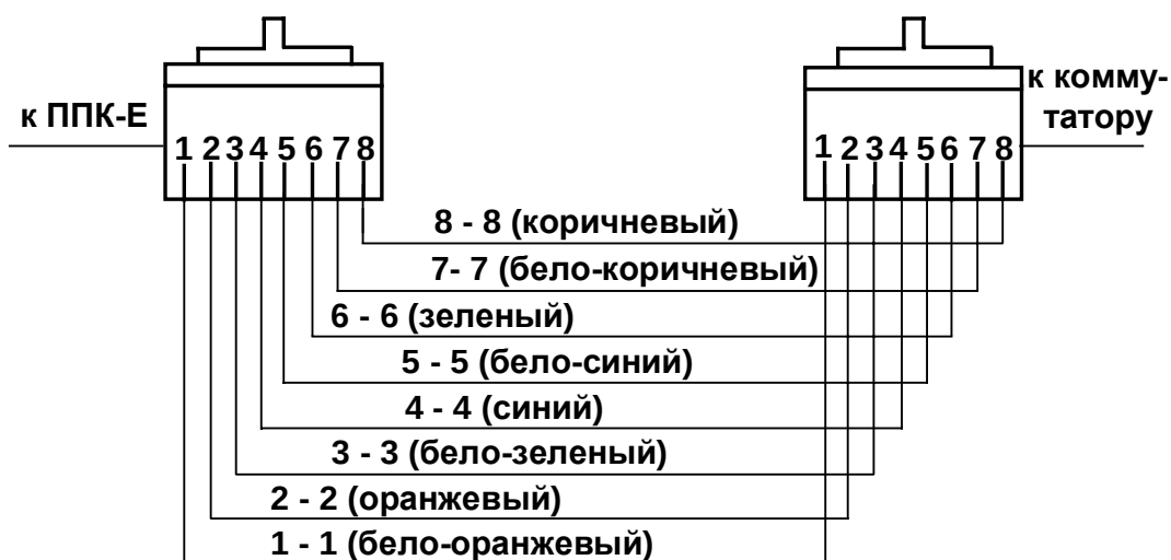
б) Прямой кабель (соединение ППК-Е и коммутатора)
