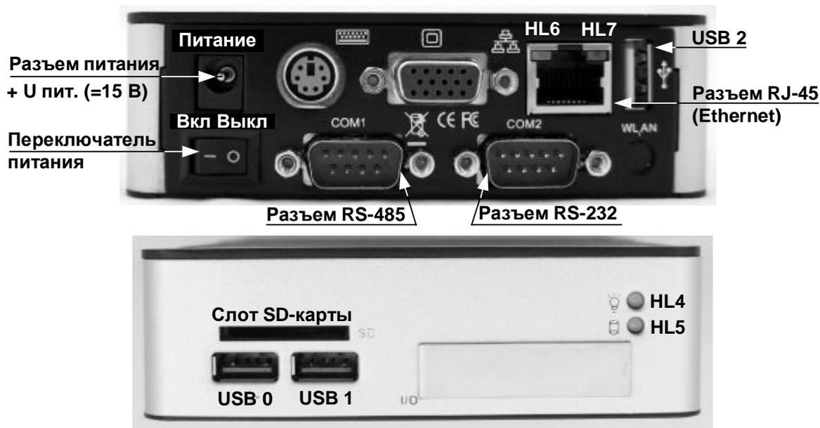
Рис. 4 Модуль процессорный, разъемы, индикаторы.
