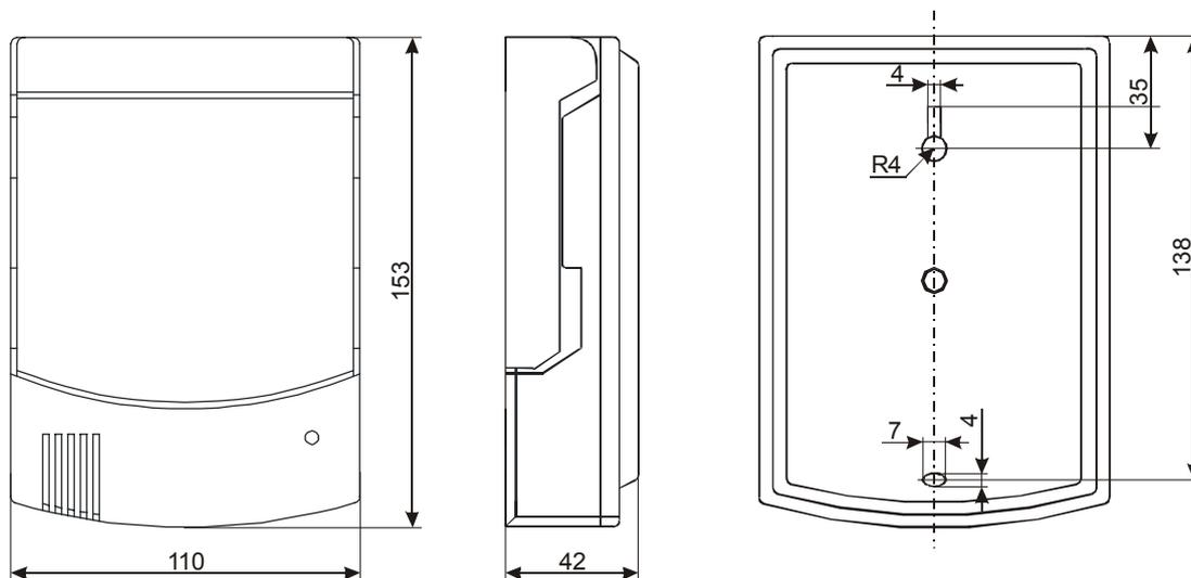
**Рис. 5** Габаритные и присоединительные размеры
