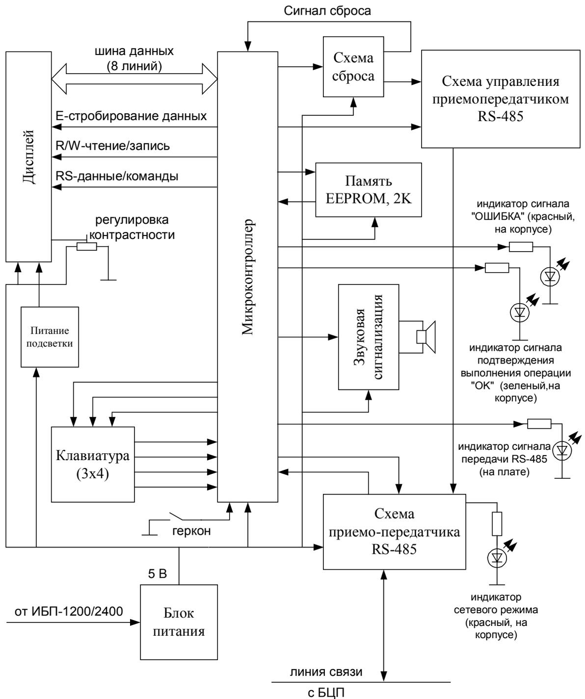
Рис. 2 Структурная блок-схема ПУО-02
