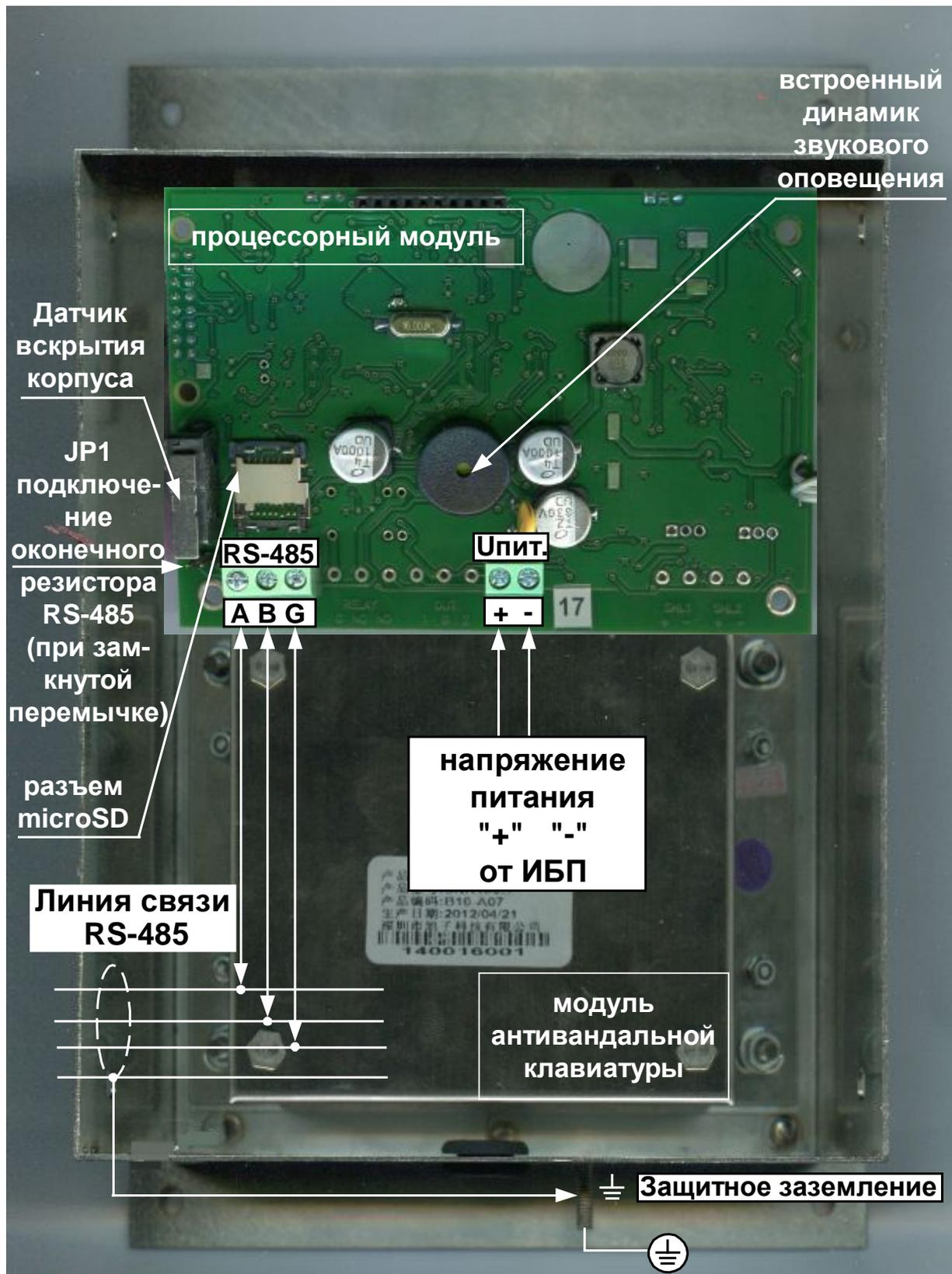
Рис. 2 Расположение элементов, подключение (вид без дна корпуса)
