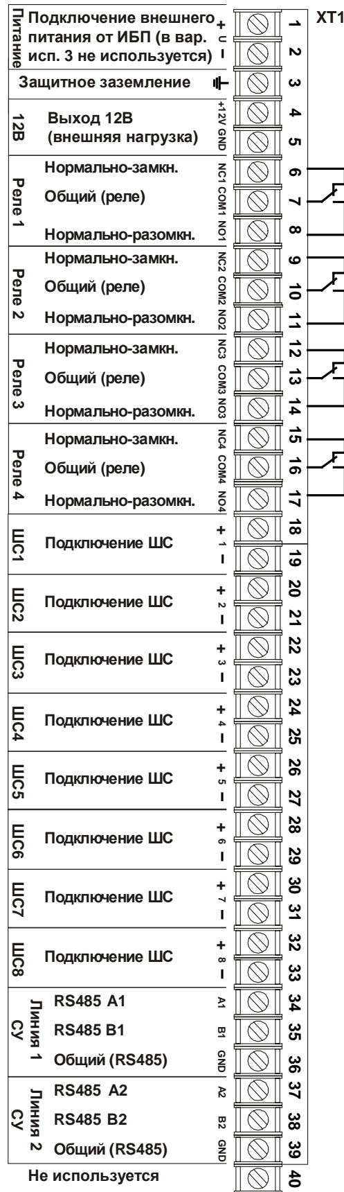
Рис. 32 Назначение разъемов ХТ1 БЦП исп.1,2,3
