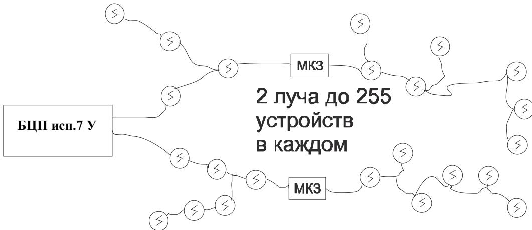
**Рис. 6 Подключение адресного шлейфа в режиме «два луча».**
