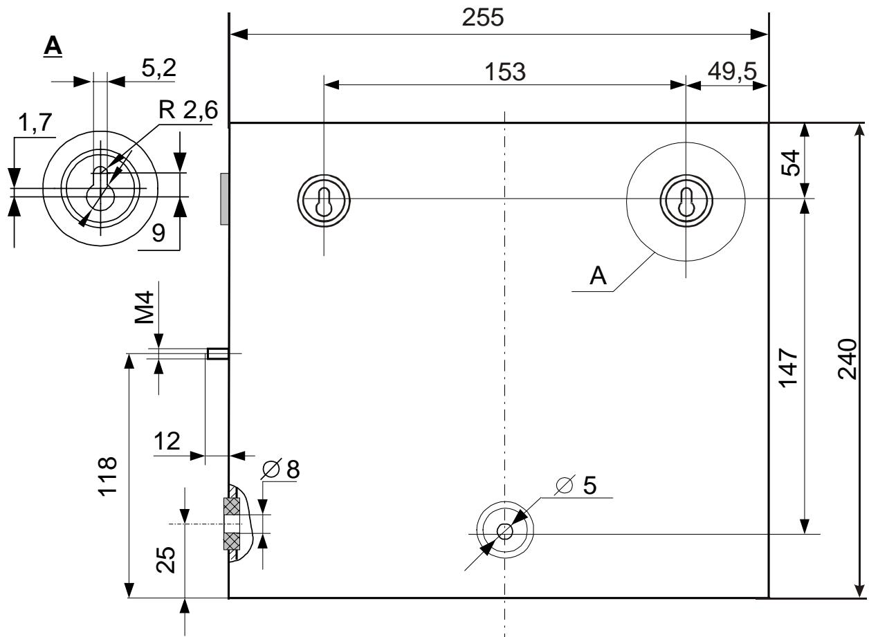
Рис. 11 Габаритные и присоединительные размеры БЦП исп. 7-1У
