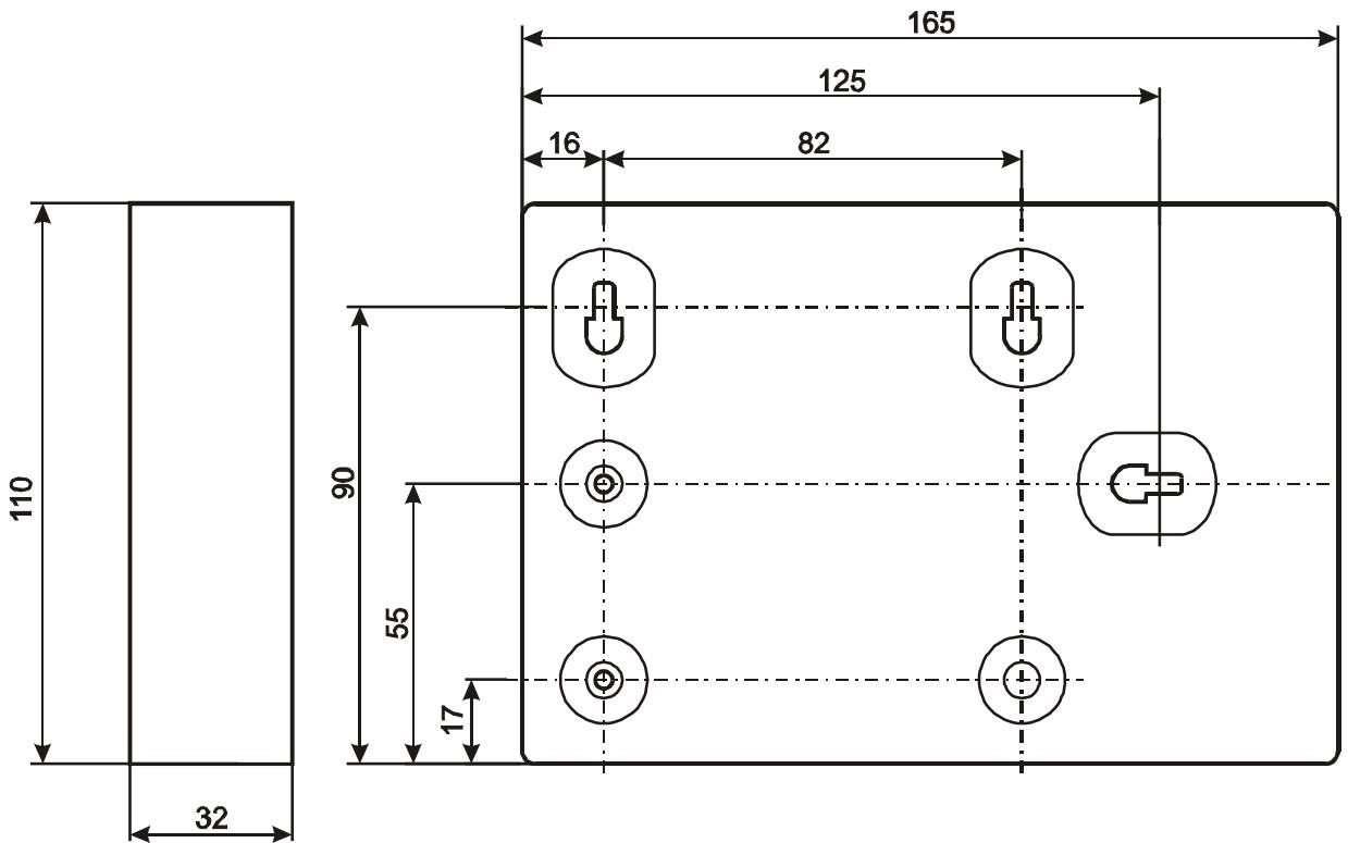
**Рис. 3 Габаритные и присоединительные размеры БЦП исп. 7У.**
