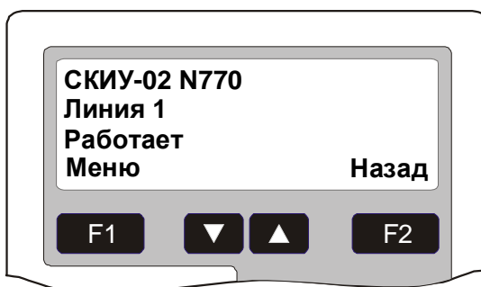
Рис. 7 Состояние работоспособности СКИУ
