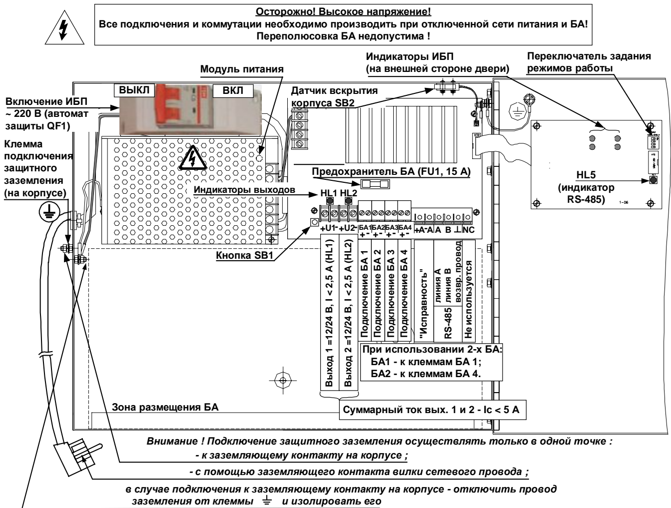
Рис. 2 Внешний вид ИБП-1200/2400 исп. 1 с открытой дверью
