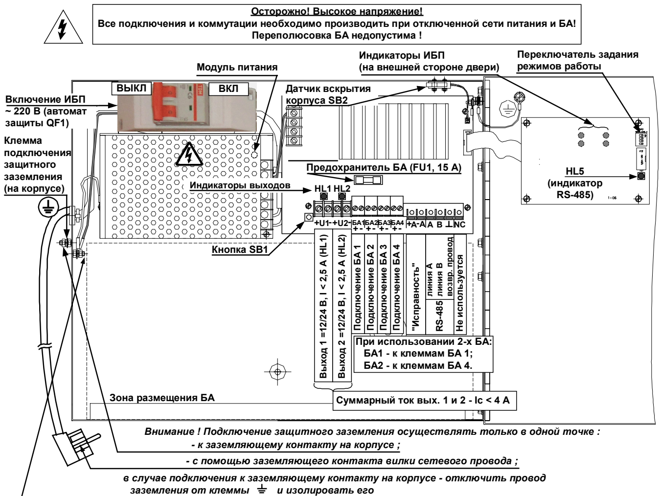
Рис. 2 Внешний вид ИБП-1200/2400 исп. 1 с открытой дверью
