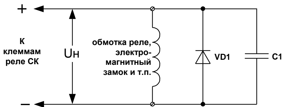
Рис. 6 Схема электрическая принципиальная шунтирующей цепи при подключении индуктивной нагрузки к клеммам реле СК
