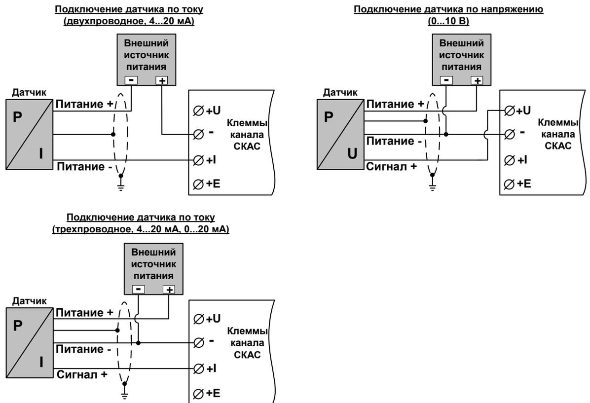
Рис. 6 Примеры подключения датчиков с использованием внешних источников питания
