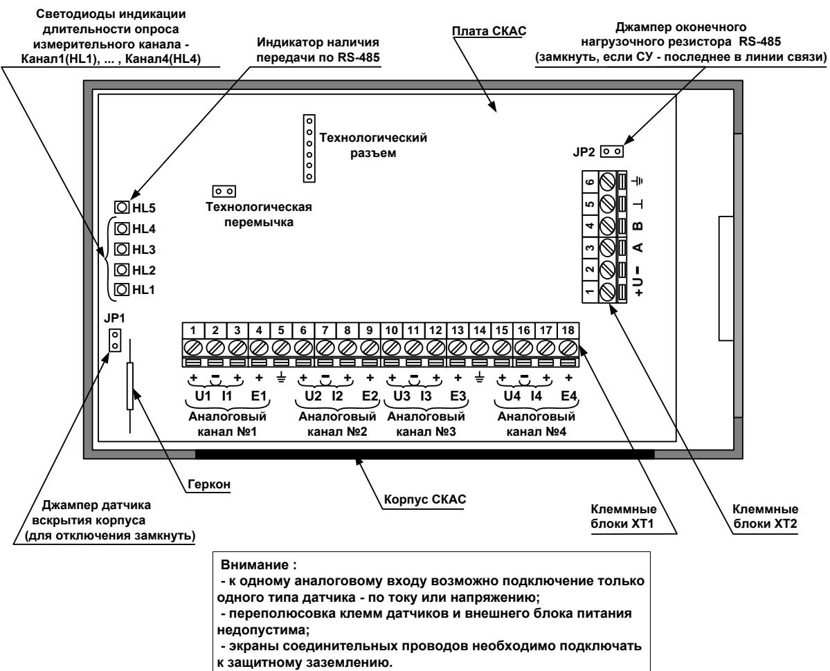
**Рис. 1 Внешний вид с обозначением элементов платы СКАС-01**
