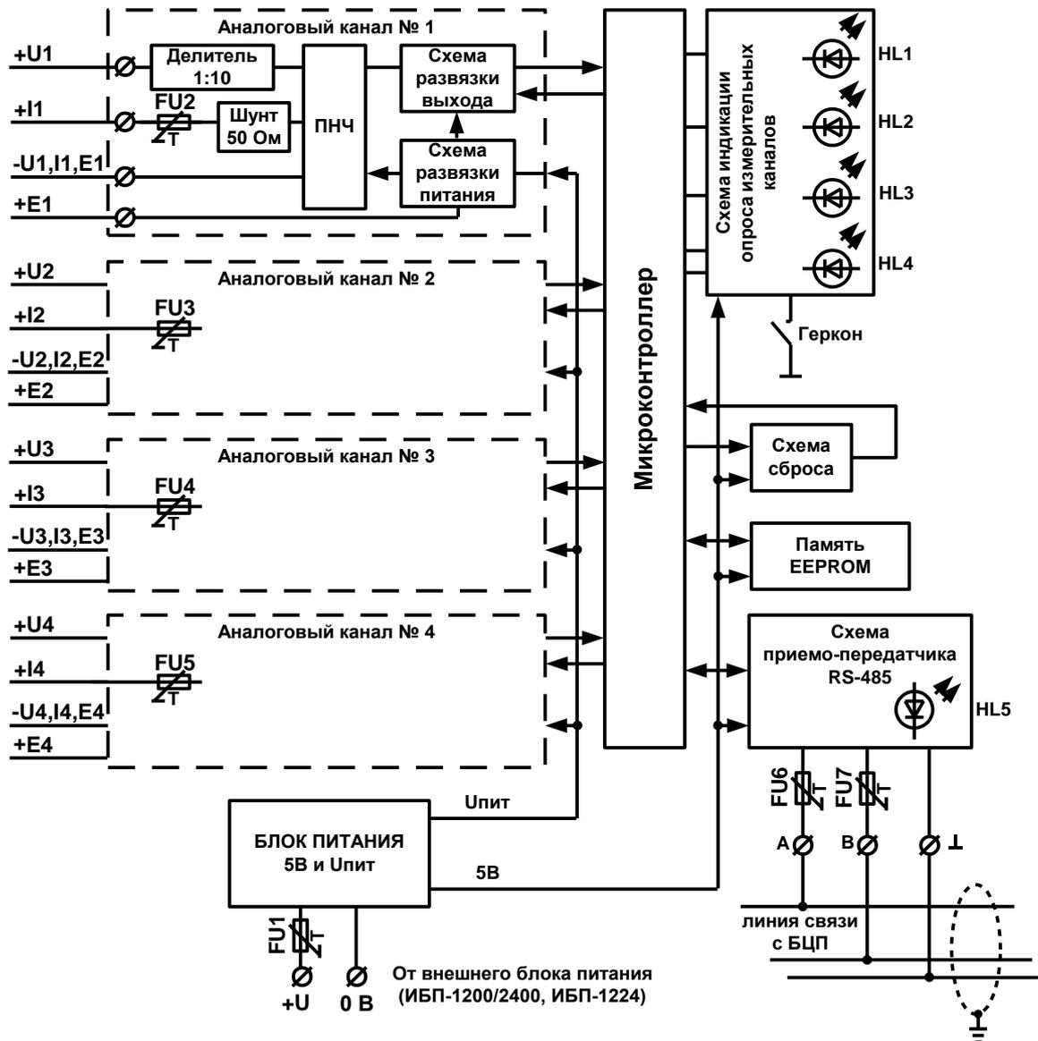
Рис. 2 Структурная блок-схема СКАС
