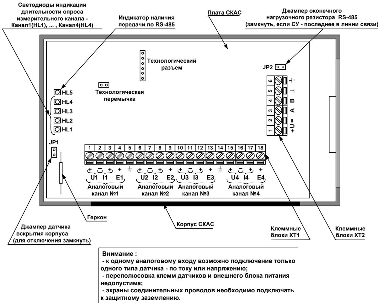
**Рис. 1 Внешний вид с обозначением элементов платы СКАС-01**
