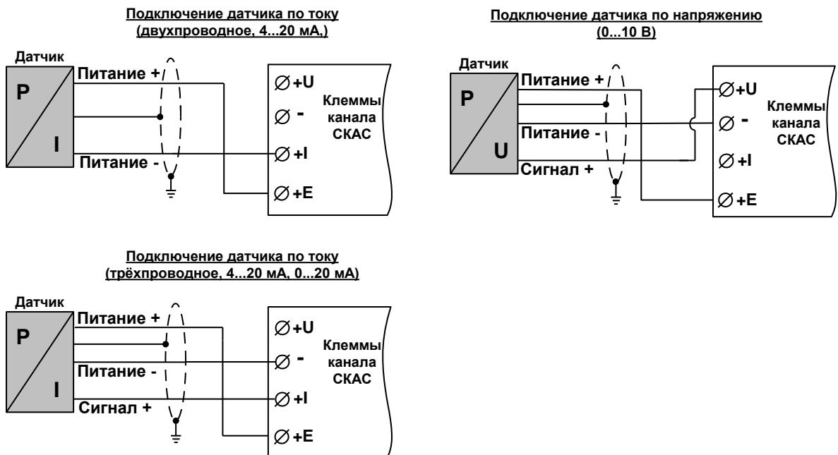
Рис. 5 Примеры подключения датчиков с питанием от СКАС
