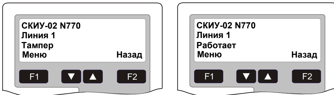
Рис. 6 Окно состояния SKIU при открытой крышке корпуса (слева) и закрытой крышке (справа)
