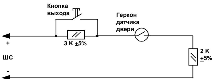
Рис. 19 ШС для контроля состояния датчика двери и приема сообщений о нажатии кнопки выхода
