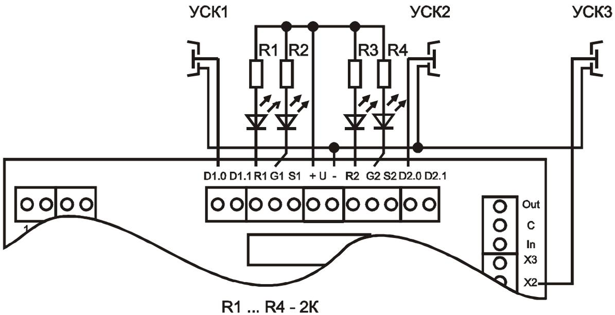
**Рис. 20 Подключение светодиодов в качестве индикаторов УСК**
