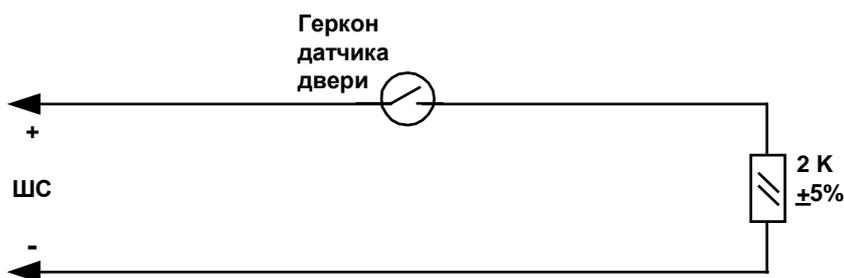
Рис. 18 ШС для контроля состояния датчика двери
