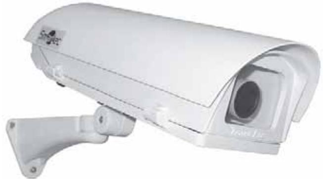
Термокожухи серии STH-3230 – это оптимальный выбор для защиты телекамеры от климатических воздействий в широком диапазоне температур. Интегрированный солнцезащитный козырек предотвращает попадание прямых солнечных лучей на стекло и появление бликов. За счет конструкции козырька создается воздушный зазор, который дополнительно предохраняет телекамеру от перегрева при высоких положительных температурах, поэтому кожухи этой серии можно особо рекомендовать для IP-камер.
