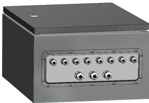
Рис.8 – Шкаф коммутатора (вид снизу)
