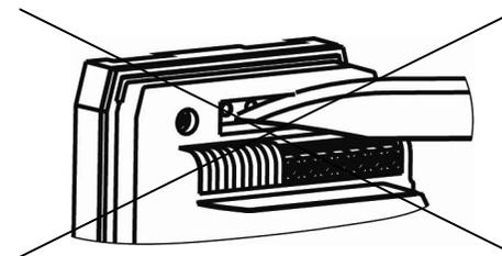
В герметизирующей прокладке прокалывайте отверстие для ввода кабеля крестовой отверткой
