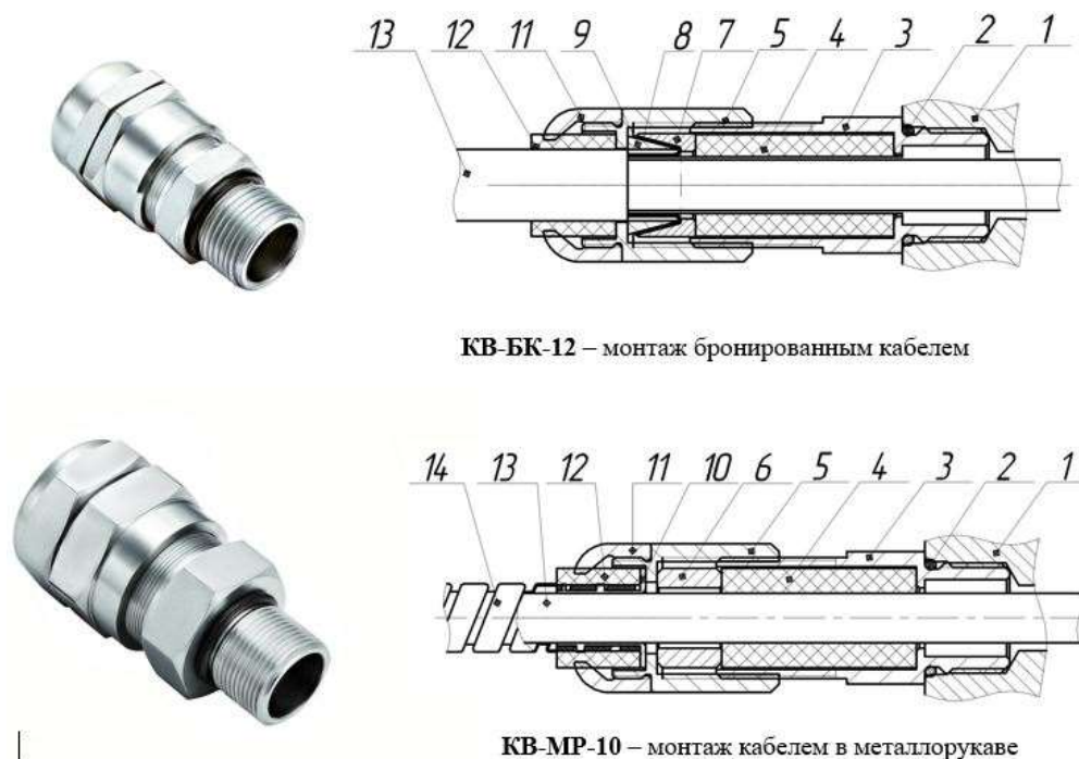
Рисунок 7 – Вводные устройства с двойным уплотнением
