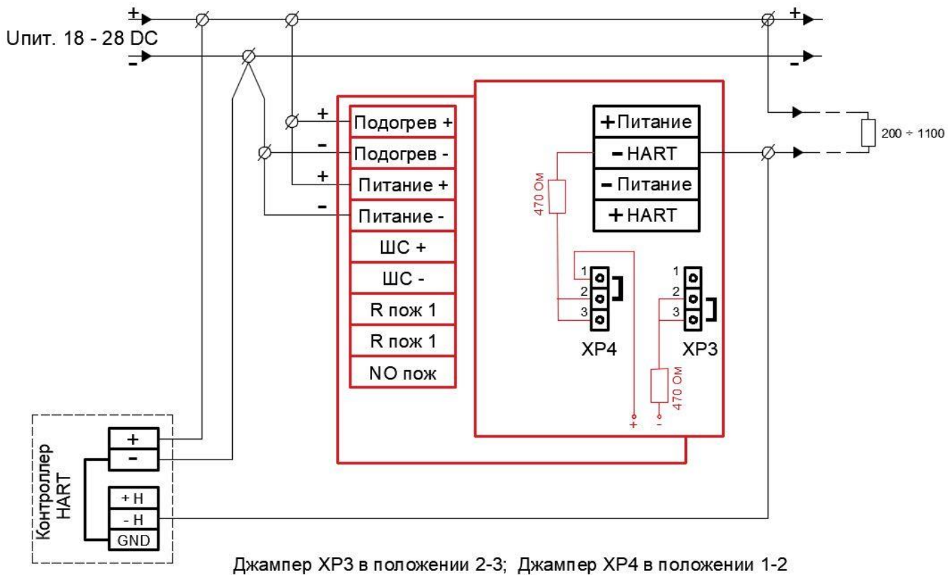
Рисунок 8 – Схема подключения по интерфейсу HART с втекающим током
