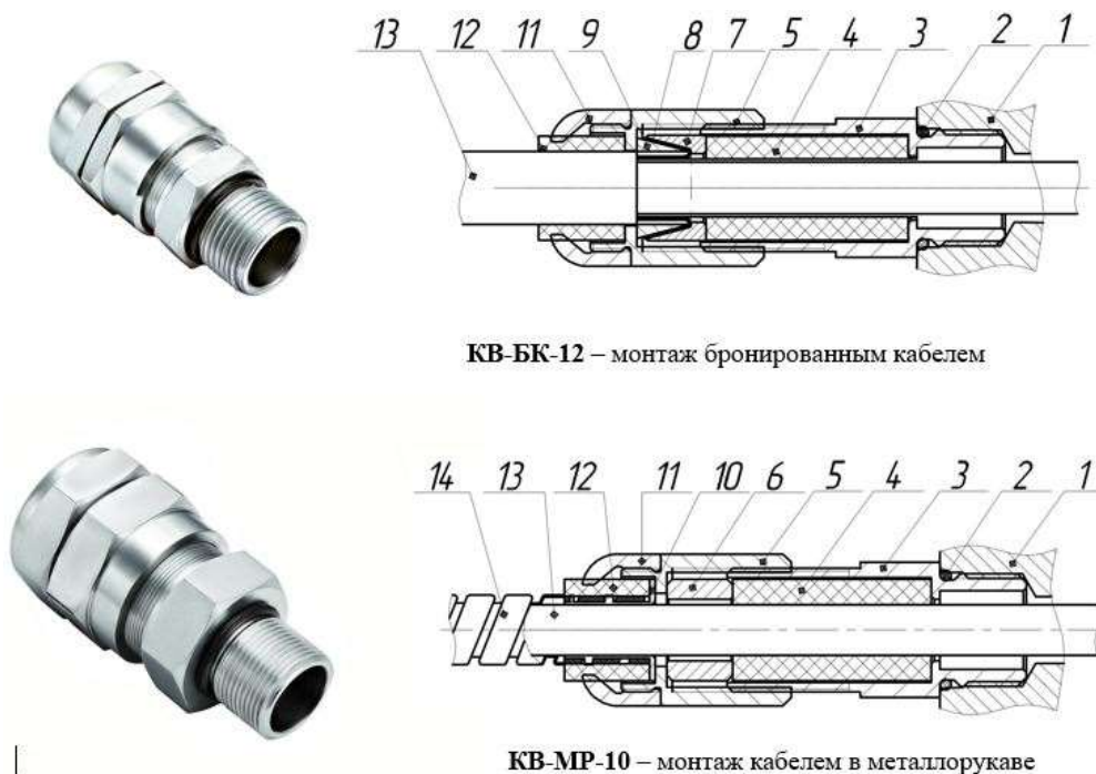
Рисунок 12 – Вводные устройства с двойным уплотнением
