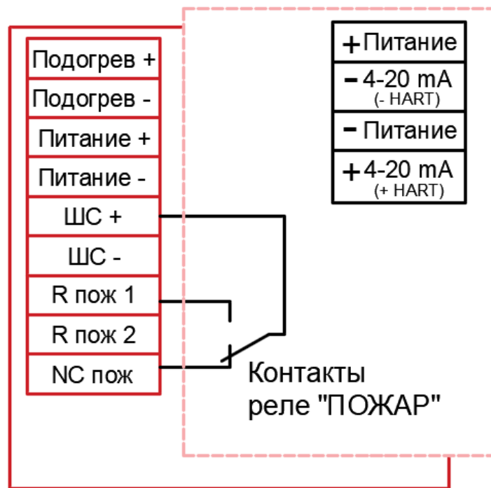
Рисунок 10. Схема расположения контактов реле «Пожар»
