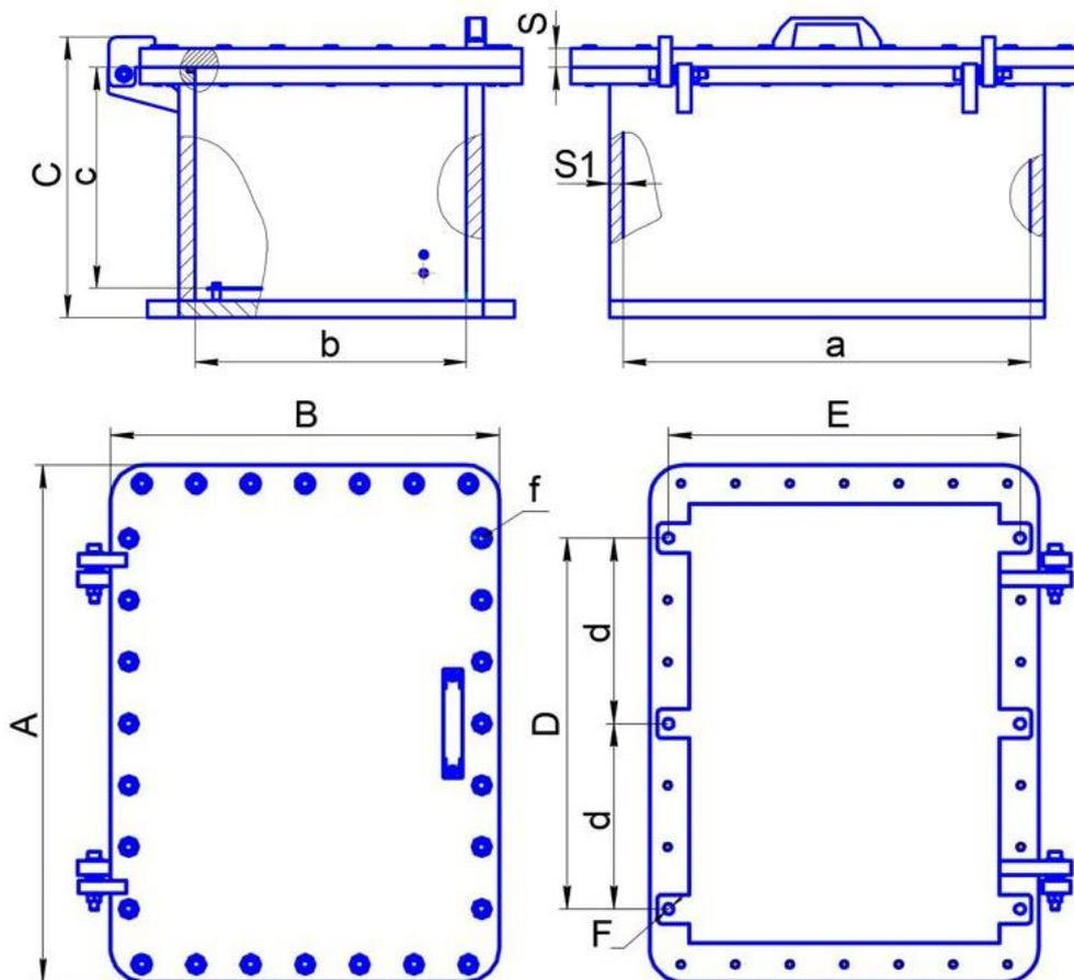
Рисунок 1. Внешний вид и габаритные размеры сварной коробки.
