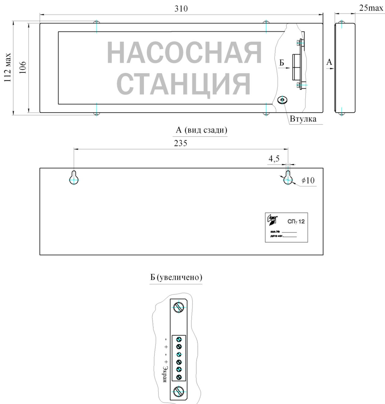
Рисунок 3.4 Оповещатель СПу 12. Габаритный чертёж
