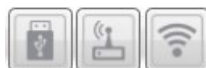
Рис. 7.21. Кнопки для выбора канала записи конфигурации (слева направо: USB; DATA; TCP/IP GPRS)
