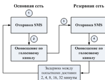
Рис. 4.3. Алгоритм оповещения в режиме автономной охраны
