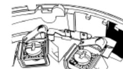
База оснащена механическим устройством, которое, после его активизации, обеспечивает надежное крепление при вибрации и не позволяет снять оповещатель без использования специального инструмента.
