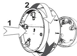
тембра и громкости с помощью ДИП-переключателей. Установите устройство в базу и поверните его по часовой стрелке до щелчка. Между выводами базы 2 и 4 установлен пружинный контакт, фиксирующийся в замкнутом и разомкнутом состояниях. Замыкание этого контакта облегчает проверку (прозвонку) шлейфа сигнализации до установки оповещателей. Его размыкание происходит автоматически при установке оповещателя в базу.
