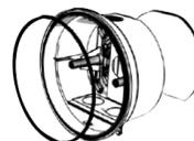
Для обеспечения степени защиты IP-65, установите прокладку на основание базы и уплотнительное кольцо после установки базы.
